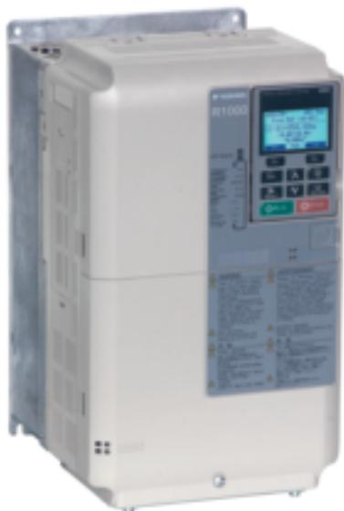
R1000 è una unità rigenerativa di frenatura a 4 quadranti, ad alta efficienza energetica, che rappresenta l'alternativa ideale alle normali resistenze di frenatura per installazioni singole o multiasse; durante le fasi di frenatura, l'energia che con le normali resistenze di frenatura verrebbe dissipata sotto forma di calore, viene rigenerata in rete, permettendo così un notevole risparmio energetico. R1000 viene venduto in KIT che comprende R1000 più la reattanza di soppressione corrente.
