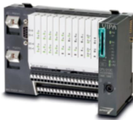
Altra caratteristica della tecnologia SPEED7 è la possibilità di avere CPU con memoria espandibile, fornibili con una memoria di lavoro e di programma base, e la possibilità di estenderla tramite MCC configurata. Nelle CPU SLIO questo attributo è stato ulteriormente potenziato con la possibilità di utilizzare SD card che, caricate con opportuni files, divengono VSC che possono, oltre che espandere la memoria, anche abilitare porte di comunicazione.
