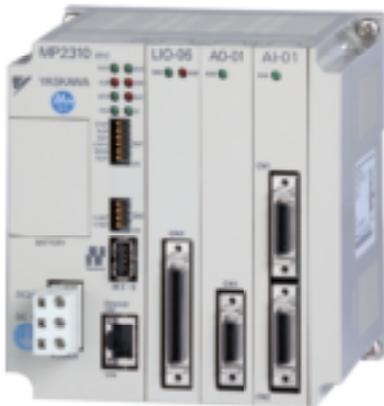
l'MP2310 è una CPU che può controllare fino a 16 assi. E' dotata di 3 slot a per eventuali schede di espansione, encoder esterni, I/O , etc.
