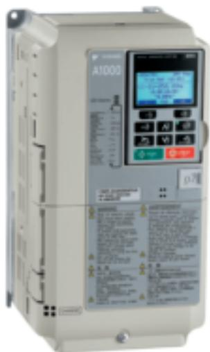
L'inverter A1000 con controllo vettoriale ad alte prestazioni permette di comandare sia motori ad induzione che motori sincroni a magneti permanenti interni IPM, che a magneti permanenti esterni SPM e permette un controllo ad anello aperto o chiuso con coppia nominale a velocità zero.
