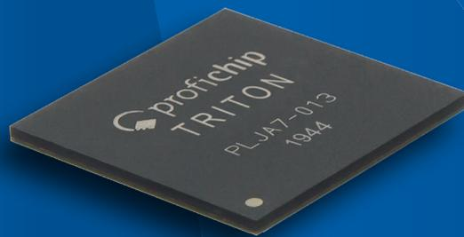
Triton combina la comunicazione Gigabit Ethernet industriale con un sistema backplane veloce e affidabile, nonché un potente processore multicore di movimento/automazione in un unico prodotto con bassa dissipazione di potenza.
